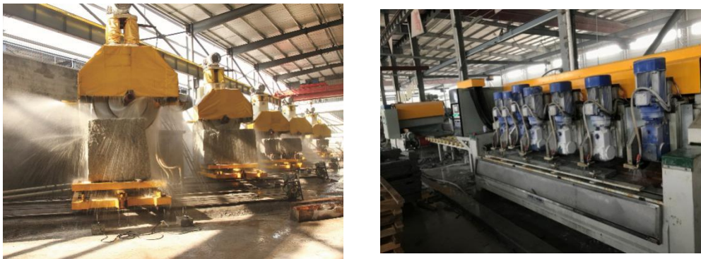
图 3-8 石材厂大切车间（左）和切边车间（右）
