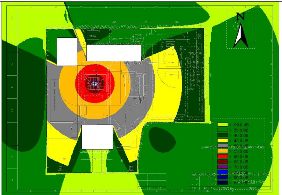
图4-4 黄舟110kV变电站扩建#1主变噪声贡献等声级线图
