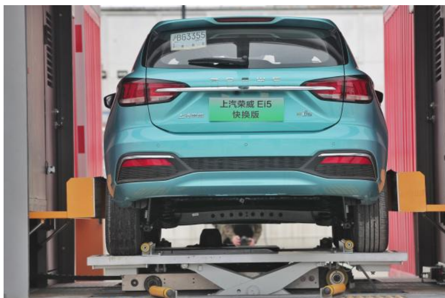
图 4-16 上海首家多品牌共享的新能源车换电站
