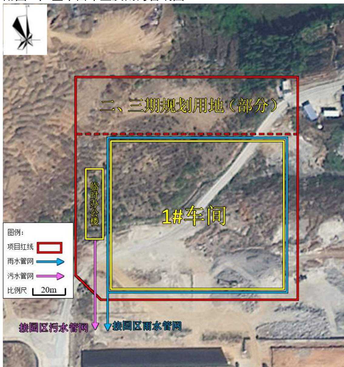
附图 3 厂区平面布置及雨污管线图
